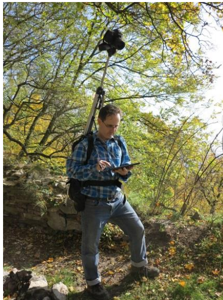
Obr. 1 Použitý systém PhotoModeler Scanner DynEX3D umožňuje snímať peši aj autom.
